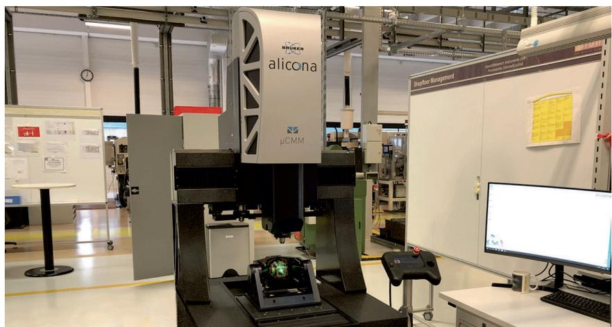
Bild 2. Das Bruker Alicona  $\mu$ CMM wird im Rahmen des Projekts ProIQ zur Umsetzung adaptiver Produktionsstrategien eingesetzt. © Dentsply Sirona
